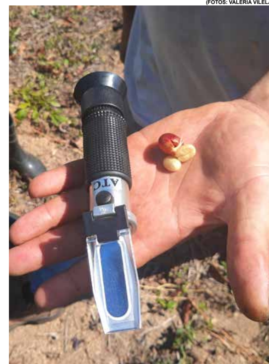
Flávio e Juliana casal usa aparelho para manter padrão de cafés especiais. Refratômetro para medir quando de açúcar tem em cada talhão.
