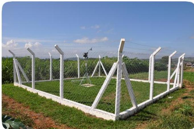
A estação meteorológica tem sensores de pressão atmosférica, precipitação, temperatura, umidade relativa, radiação solar e anemômetro. A marca do equipamento
